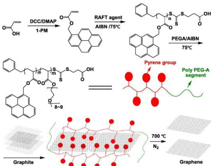
(4) 成功地制备了导电性能可控的石墨烯薄膜，主要通过分子
